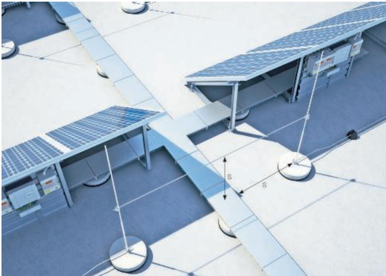
Rastojanje razdvajanja ( $s$ ) između sistema gromobranske zaštite i sistema nosača kablova
