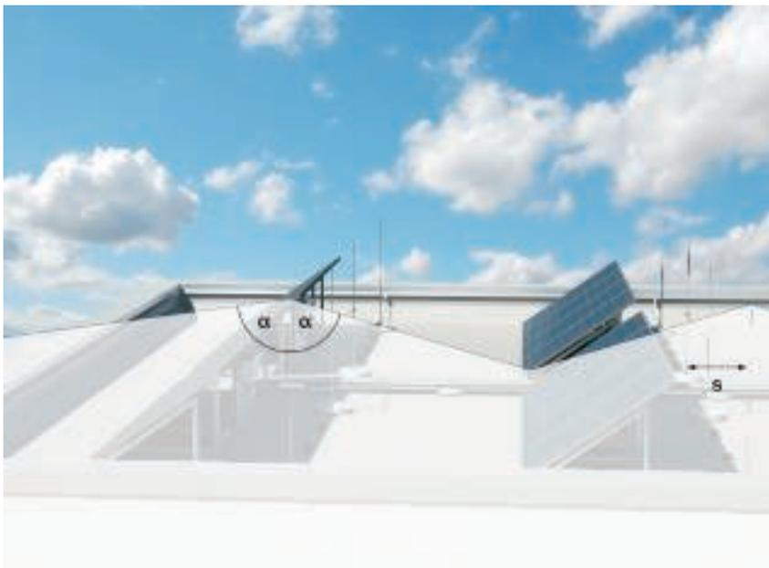
$\alpha^\circ$  = ugao gromobranske zaštite, s = rastojanje razdvajanja
