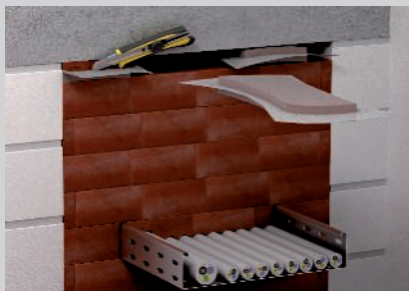
Vakuumski blokovi za jednostavno zatvaranje preostalih otvora.
